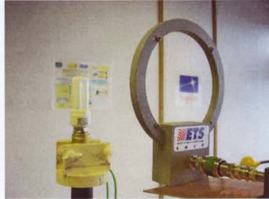
Figure 4: Le dispositif de mesure: boucle magnétique plus supports
