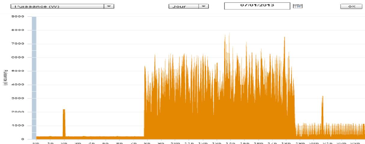
Exemple de courbe de charges avec points 10 minutes. Il correspond au suivi des consommations des bureaux parisiens d'EcoCO2, le lundi 7 janvier 2013. On voit nettement que le chauffage a été mis en marche à l'arrivée des occupants un peu avant 8h puis mis en position réduite sans être arrêté le soir en partant vers 18h40.
